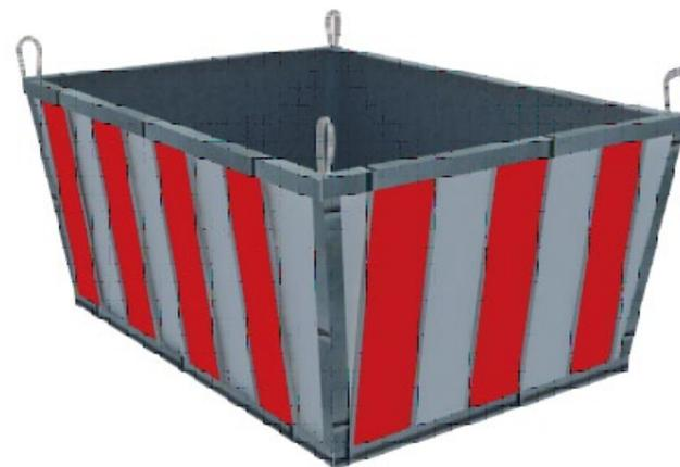
(图二) 零散构件吊运箱示意图
