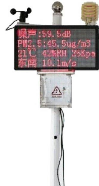
(图二) 粉尘、噪声实时监测器实物图
