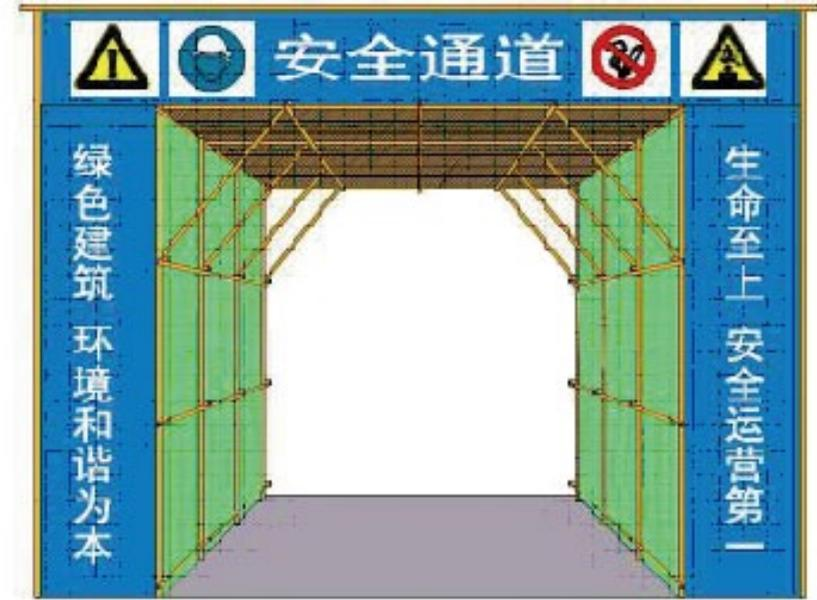
(图二) 钢管式安全通道防护棚效果图
