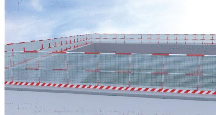
(图二) 钢管防护栏杆效果图
