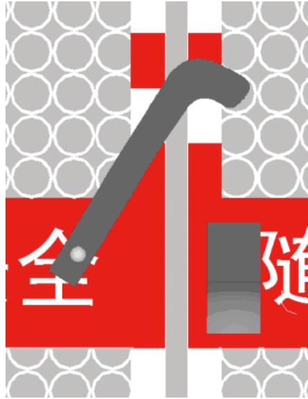
(图一) 施工升降机防护门门锁做法图
