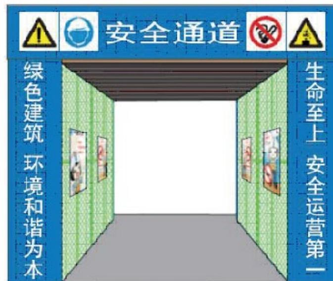
(图二) 工具式安全通道防护棚效果图
