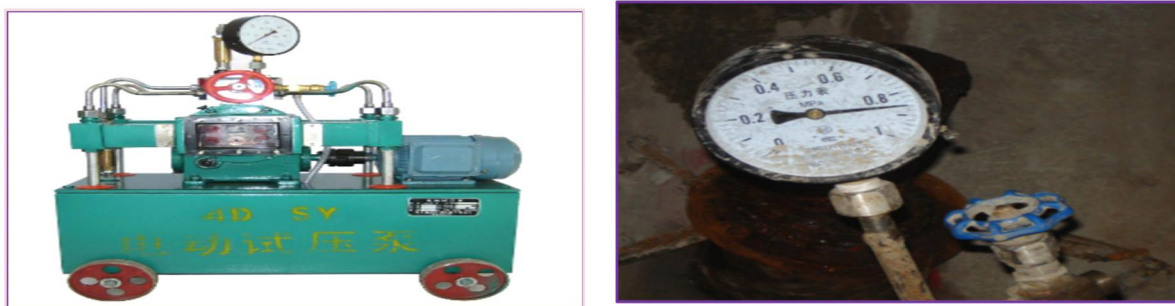
图 4-12 冻结孔试压设备及试压示意图
