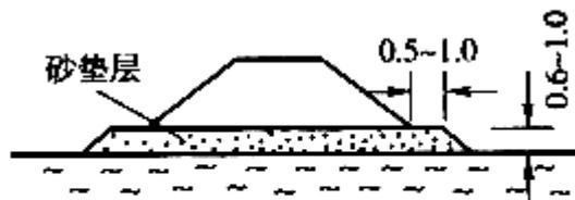
图 2-39 排水砂垫层(尺寸单位:m)
