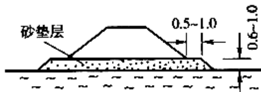
图 2-39 排水砂垫层(尺寸单位:m)
