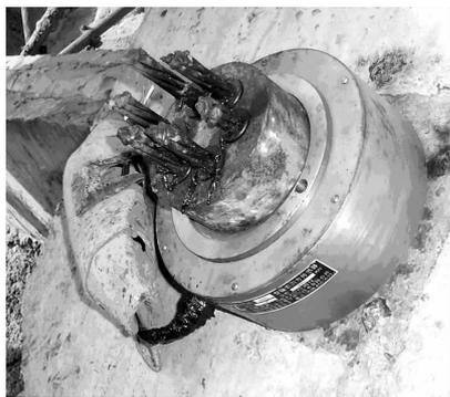
图2 已经装上的锚杆测力计
