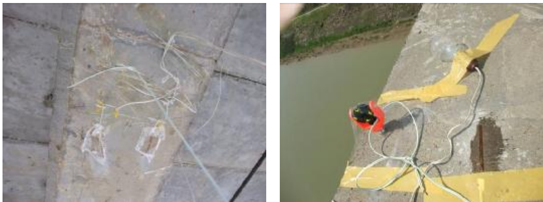
图 9.6.2 布置好的应力和位移测点
