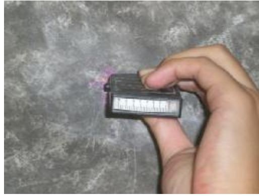
图 8.1.1 碳化深度测试照
