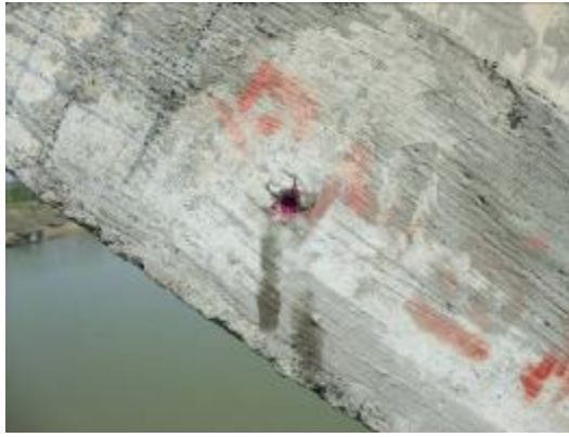
图 8.1.1 碳化深度测试照
